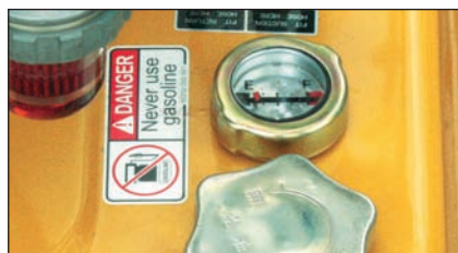
VAL со стандартным измерителем содержимого бака (нет на VAL 6 KB).
