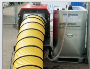
MULTITANKS, максимальная вместимость с максимальными размерами для хранения топлива котельной (ознакомьтесь с местными правилами).
